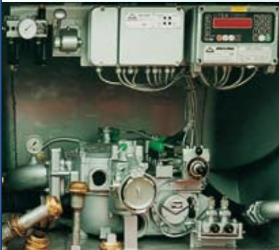
Armaturenschrank auf einem Straßentankwagen
